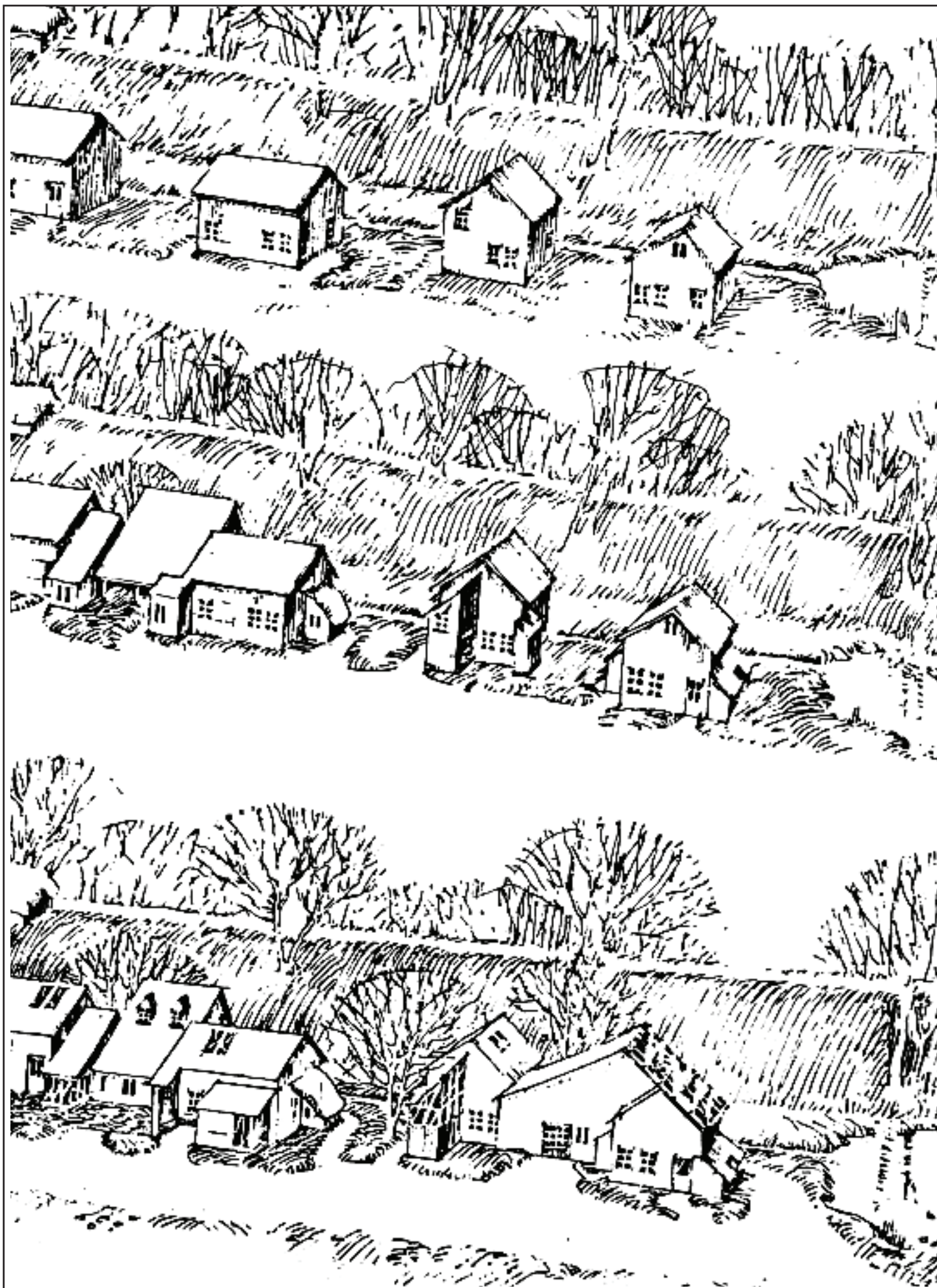
Fra Christianias Grønne plan, 1991 (Øverste række: Kærnehusene - rækkerne under viser kærnehusene med knopskydninger): Kærnehuse: idéen er at et håndværkersjak opfører en række minimumsboliger på ca. 25 m 2 . Husene forsynes med et 12 volts elsystem incl. sol-panel, solfanger til brugsvand, sydvendt glasfacade (passiv solvarme), fælles brandfyret varmecentral, varmelager i volden, regnvandstank, fællesspildevands-sump med karper, siv og springvand og multitolletter. Disse boliger udbygges efterhånden som man får behov og råd.
